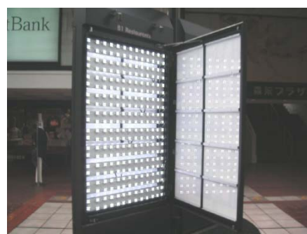
LED灯を使用した広告塔
